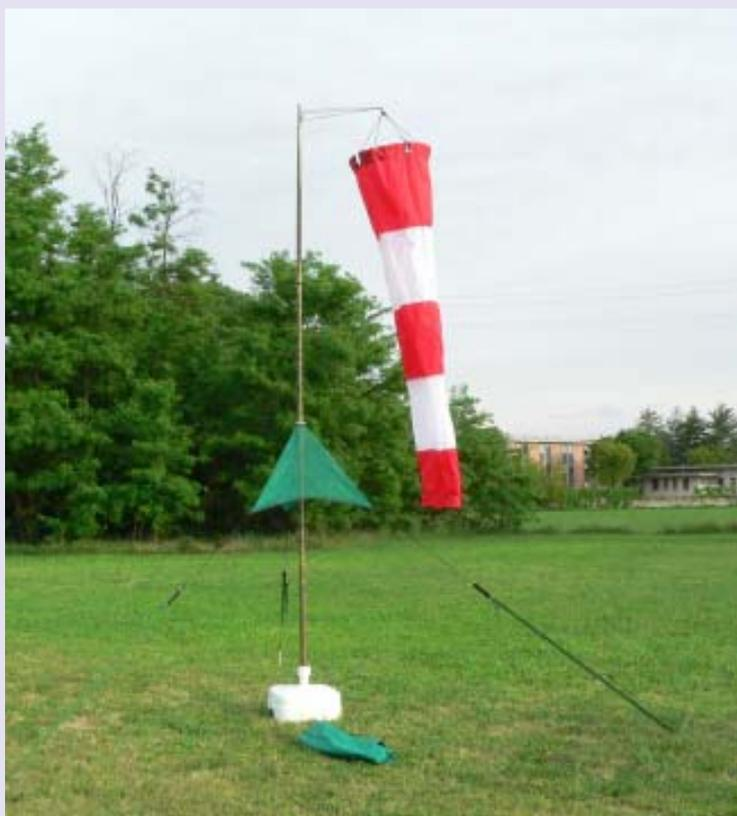
Per un corretto funzionamento è indispensabile controllare la messa in bolla del palo, regolando quest'ultima operando sui cordini di connessione fra il palo e i picchetti.
